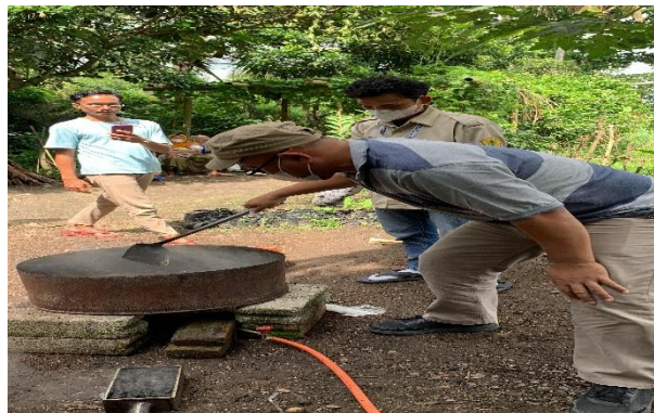
Gambar 6. Proses Pengadukan Bahan Bata Ringan
