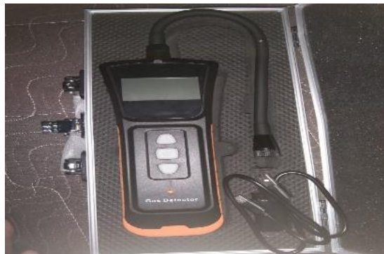
Gambar 2. Gas Detektor (Dokumentasi Pribadi)
