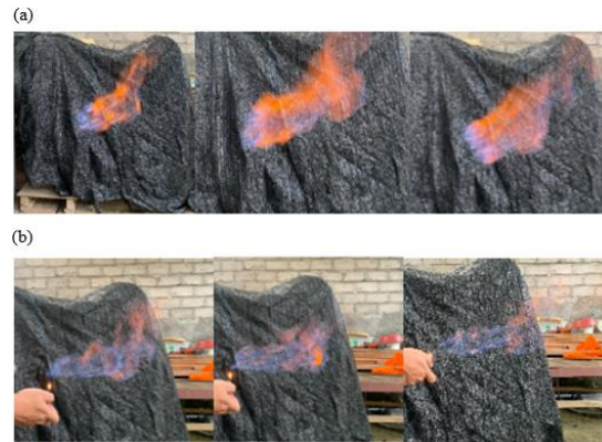
Gambar 11. Perbandingan Warna Nyala Api Biogas (a)Non Purifikasi (b)Purifikasi
